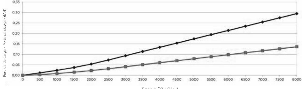
N.B.: Pruebas efectuadas en cartuchos nuevos en contenedores AQUA - Presión entrada 3 BAR - Temperatura agua 20°C/ N.B. : Tests effectués sur des cartouches neuves dans des corps de filtres AQUA - Pression d'entrée 3 BAR - Température de l'eau 20°C/
